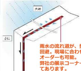
雨水の流れ道が、壁面の汚れを回避。現場に合わせて、長さのオーダーも可能。弊社の展示コーナーにも設置してあります。
