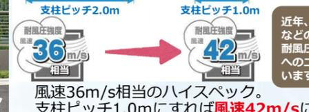
風速36m/s相当のハイスぺック。支柱ピッチ1.0mにすれば風速42m/sにアップ!
